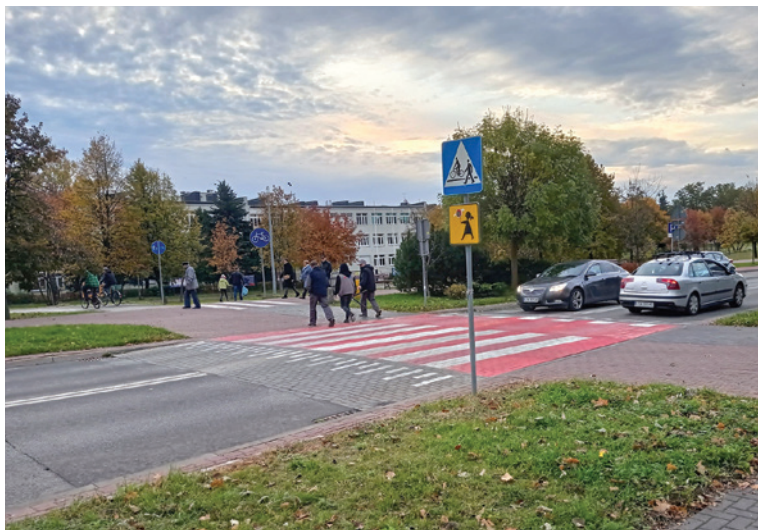
Wyniesione przejście dla pieszych wraz z przejazdem dla rowerów, które poprawiło bezpieczeństwo w drodze do Szkoły Podstawowej nr 5 w Świdniku.
